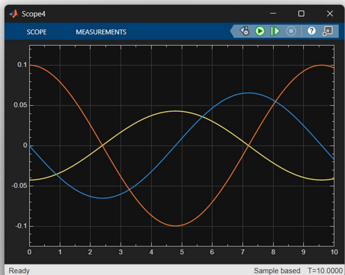
Rysunek 9 - obiekt inercyjny II rzędu, z dwoma integratorami, bez wymuszenia
