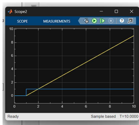
Rysunek 6 - model 4 - odpowiedź układu na skok jednostkowy
